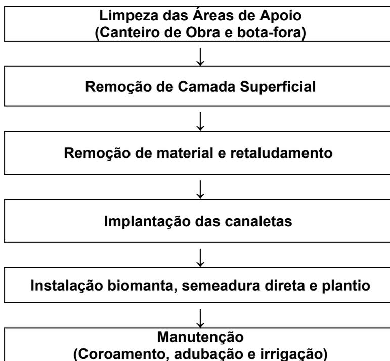
É informado que na operação de retaludamento, o processo de corte e transporte do material escavado será realizado por trator de esteira, escavadeira mecânica e pá carregadeira. Foi estimado um volume de 104.630,00m<sup>3</sup> a ser movimentado e retirado do local exigindo, portanto, um depósito temporário de material (bota-fora) e que se realize a destinação com o aproveitamento mineral.
