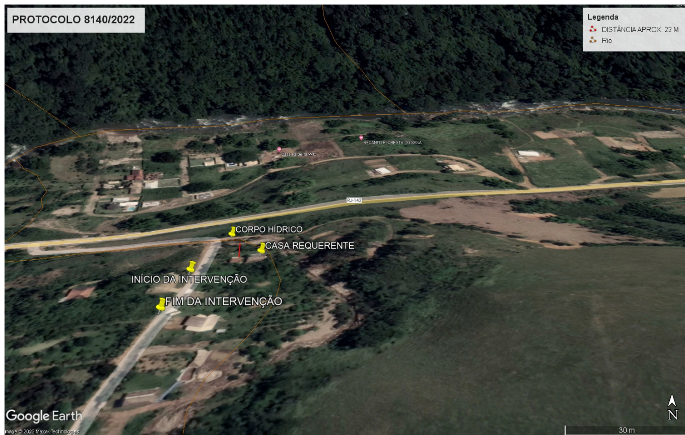
FIGURA 3: Descrição da rede de drenagem natural em relação a área de Intervenção, imagem obtida pelo Software Google Earth.
