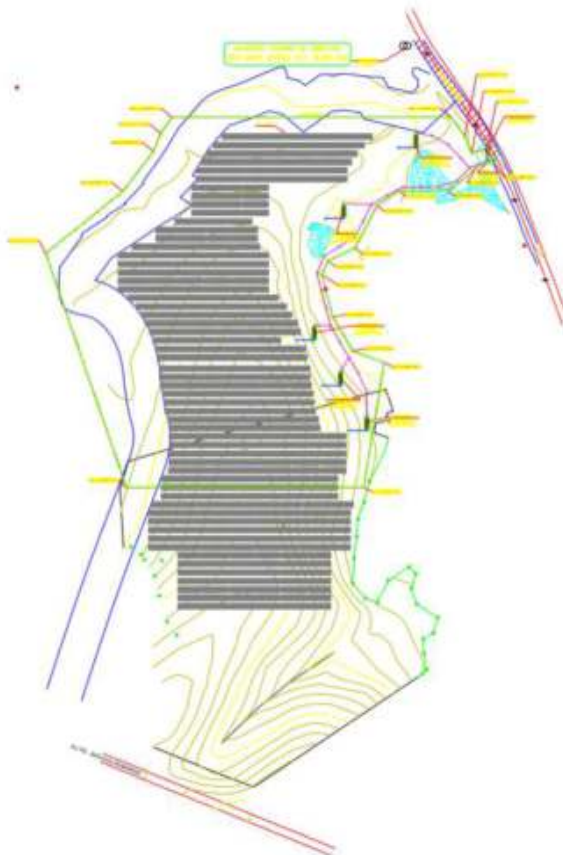
FIGURA 3: Desenho do projeto, respeitando a faixa marginal de proteção de 30 metros do corpo hídrico e dos espelhos d'águas.
