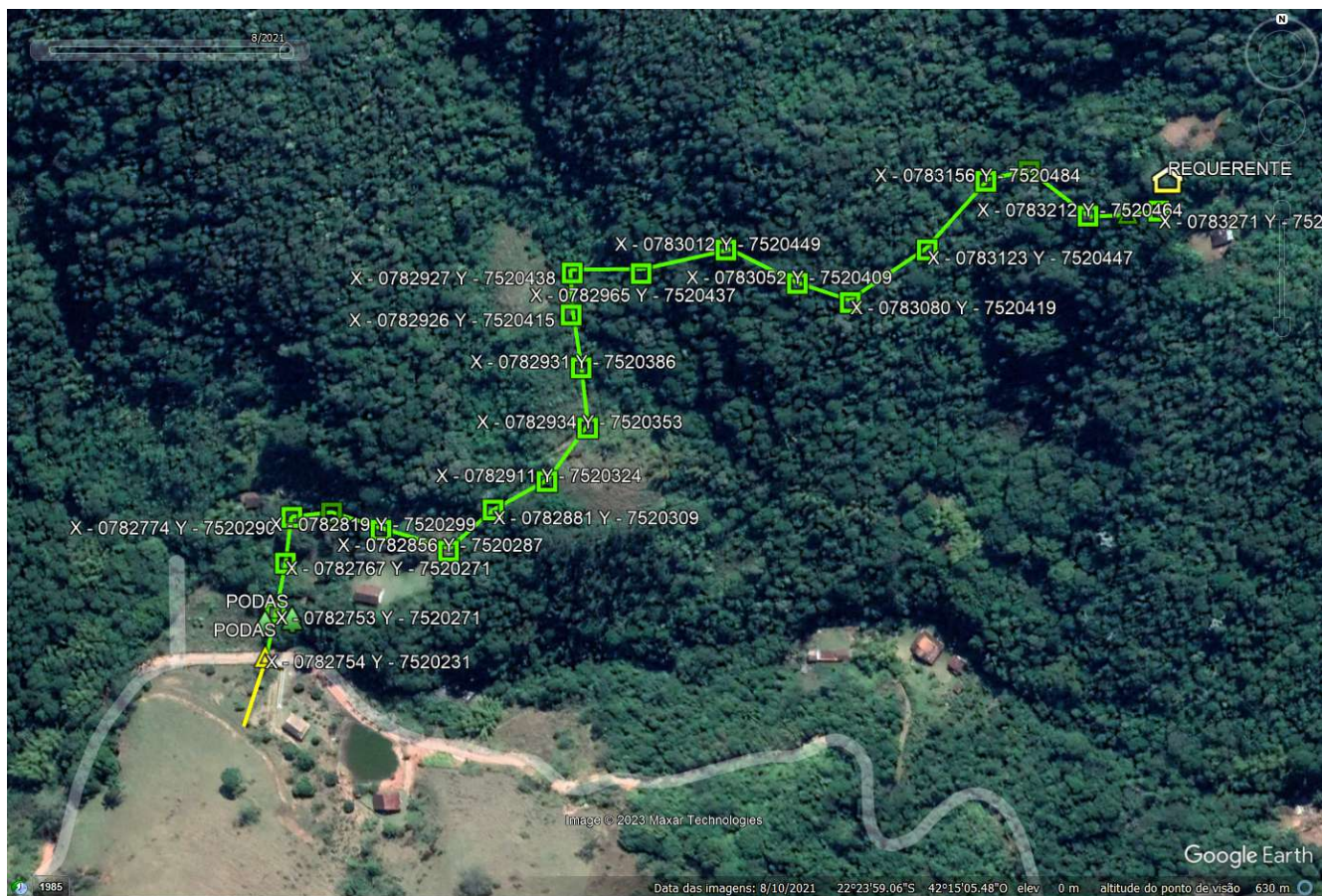
FIGURA 1: Descrição do traçado da rede projetada, imagem obtida pelo Programa Google Earth.
