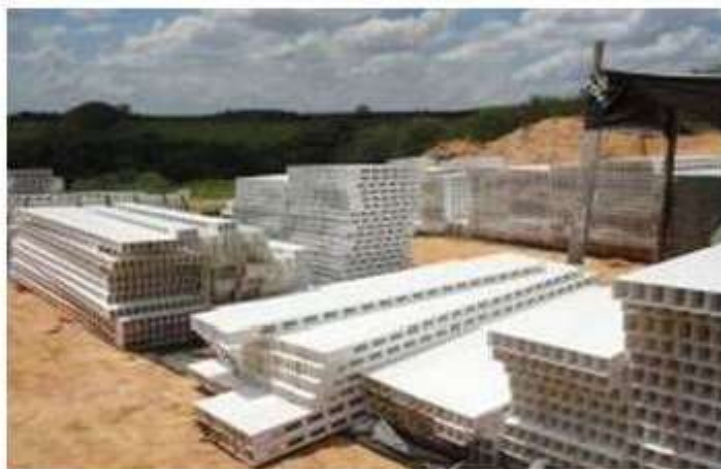
Figura 10 – Painéis de PVC pré-moldados na fábrica
