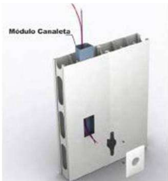
Figura 4 – Perfil canaleta dentro do módulo básico e vista de abertura para a fixação de caixinha elétrica
