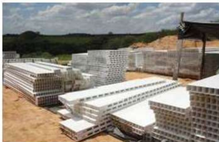
FIGURA 21 – Painéis de PVC pré-moldados na fábrica
